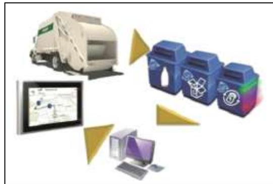
El sistema se basa en la implantación de sensores de llenado en los contenedores y dispositivos concentradores de información que realizan la agrupación de las medidas de llenado, así, a través de los datos recogidos por el sistema se establecen las rutas óptimas de recogida. Asimismo, a partir de los datos, se puede disponer de información para realizar la gestión de los contenedores y obtener estadísticas del servicio.
