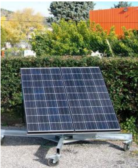
Figura No. 1 Seguidor solar
