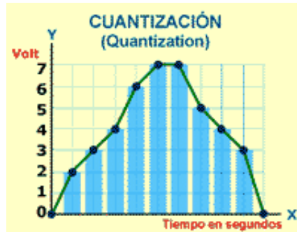
FIGURA 4. PROCESO DE CUANTIZACIÓN DE LA SEÑAL ELÉCTRICA ANALÓGICA PARA SU CONVERSIÓN EN SEÑAL DIGITAL. [8]
