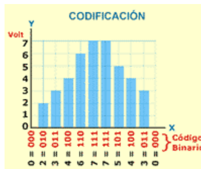
FIGURA 5. CODIFICACIÓN DE LA SEÑAL EN CÓDIGO BINARIO. [8]
