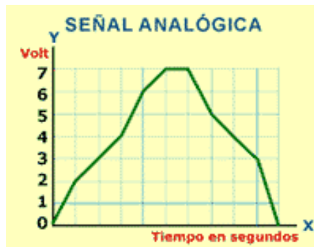
FIGURA 2. REPRESENTACIÓN GRÁFICA DE MEDIO CICLO POSITIVO (+), CORRESPONDIENTE A UNA SEÑAL ELÉCTRICA. [8]
